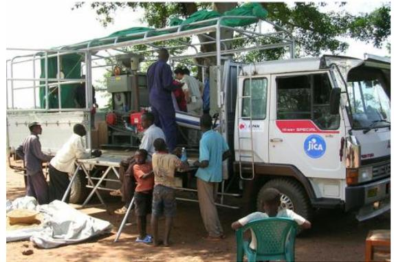
**写真 2-31 車載型精米機の例**
