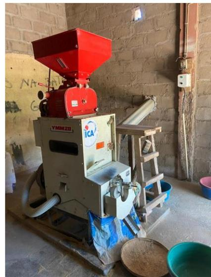
**写真 2-32 現在も稼働している粉摺精米機**
