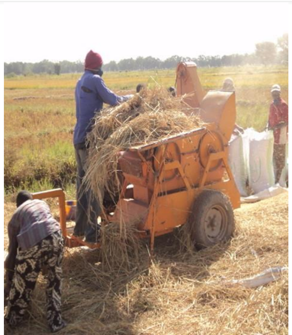
Batteuse AS fabriquée localement par CDARMA Dosso à partir d'un prototype importé du Sénégal
