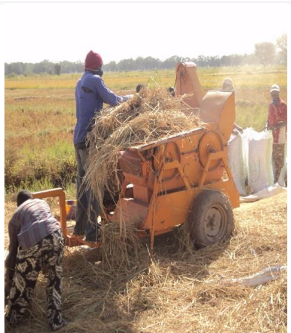
Debulhadora AS fabricada localmente pela CDARMA Dosso a partir de um protótipo importado do Senegal
