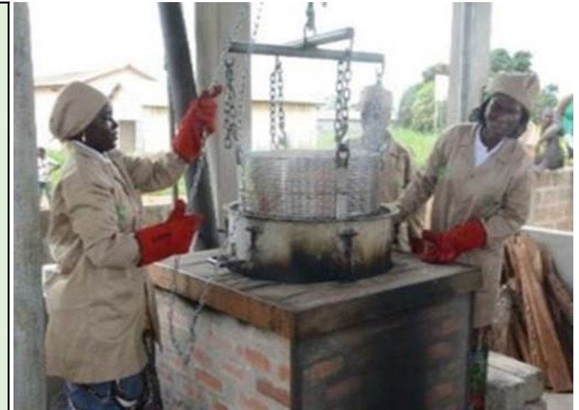
Étuvage du riz par l'entreprise RINA SARL, en Côte d'Ivoire - conditionnement du paddy pour l'usinage
