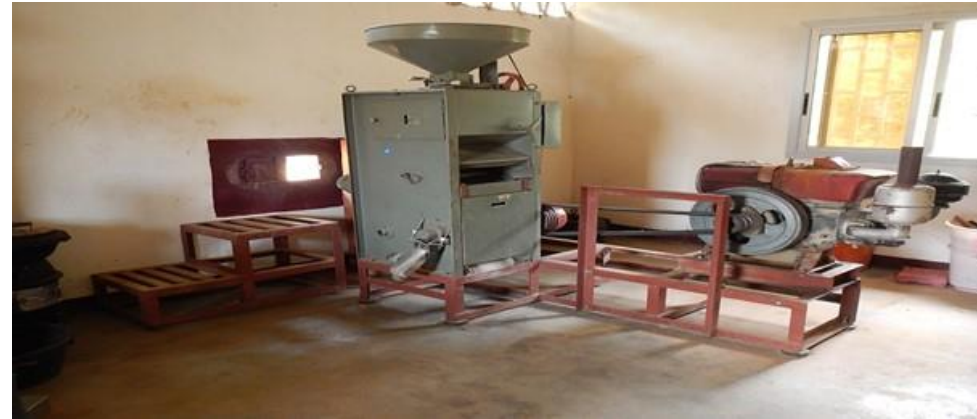
Mini-descascador SB10 instalado por um projecto de apoio numa bacia de produção de arroz emergente
